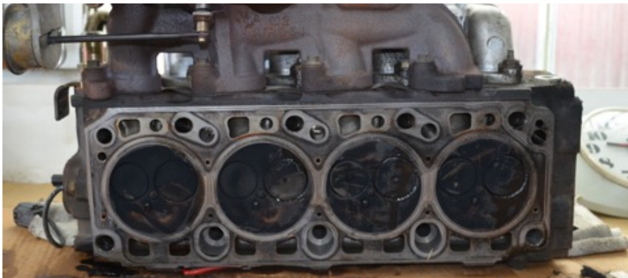
Hlava motoru Ford Focus po najetí dalších 7850 km (13 nádrží s BEP).
